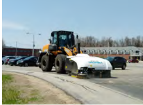
Gatusopning og PM2.5 gatudammkontroll
